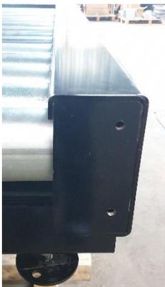
↪ Possibilité membrure haute d'un côté, et membrure basse de l'autre (pour dépose avec chariot élévateur).
