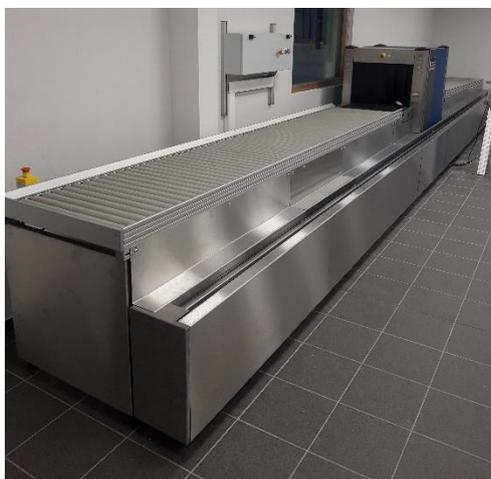
↪ Châssis en aluminium anodisé.
